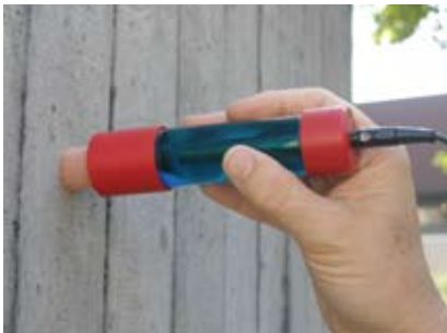
Électrode à barre ou «demi-cellule» standard
